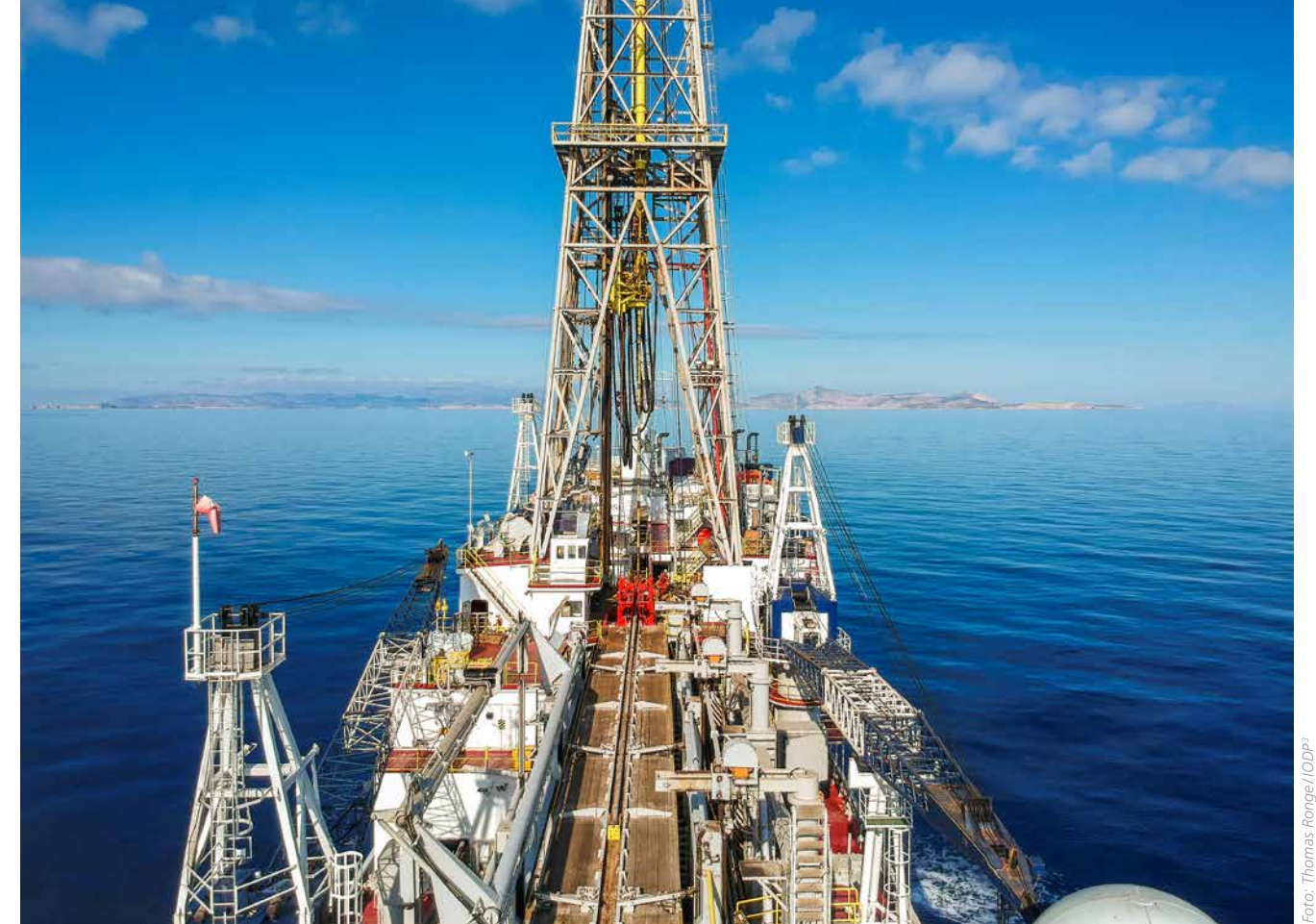
Die Joides Resolution vor der griechischen Inselgruppe Santorini: Der Bohrturm des 143 Meter langen Schiffs reicht bis 65 Meter über die Meeresoberfläche.
