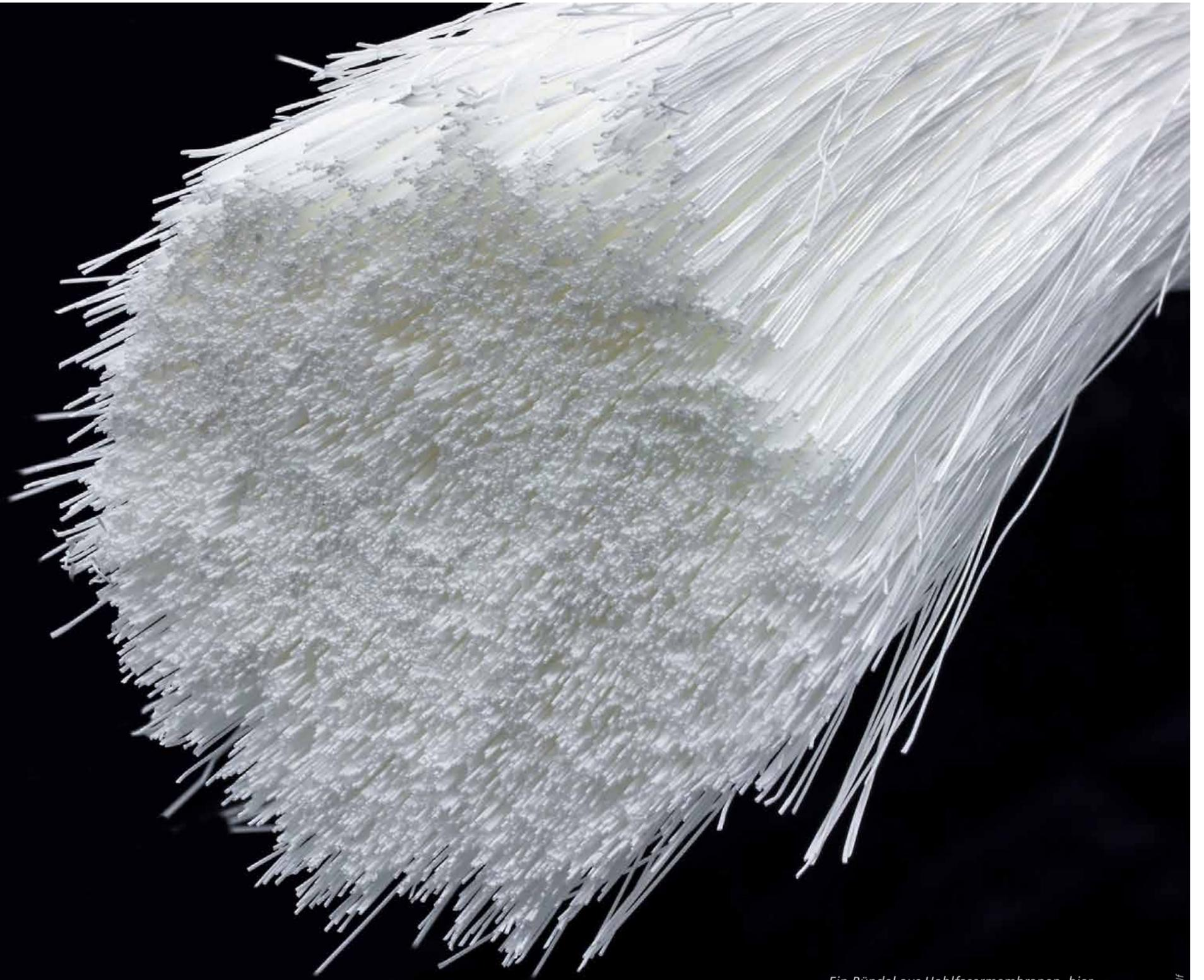
*Ein Bündel aus Hohlfasermembranen, hier Ultrafiltrationsmembranen aus Polymer.*
