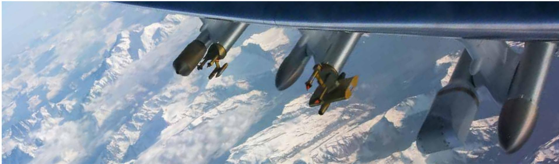
PMS-Sonden (Particle Measurement System) können bei Bedarf unter den HALO-Flügeln montiert werden. Diese Systeme erlauben hochpräzise In-situ-Messungen von Aerosolpartikeln, Wolkentröpfchen und Eiskristallen.
