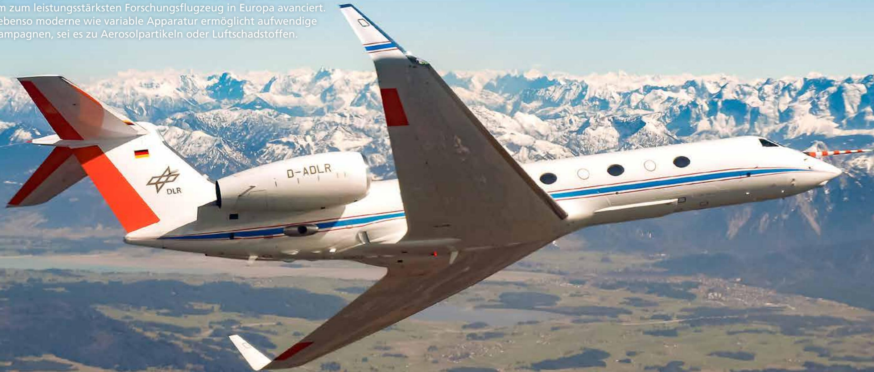
*HALO (High Altitude and Long Range Research Aircraft) fliegt seit 2010 im Dienst der Atmosphären-, Klima- und Geoforschung. Der einhornartige weiß-rote Nasenmast ermöglicht unter anderem, Windgeschwindigkeit und Luftdruck zu messen. Das Forschungsflugzeug steckt voller Messtechnik.*
