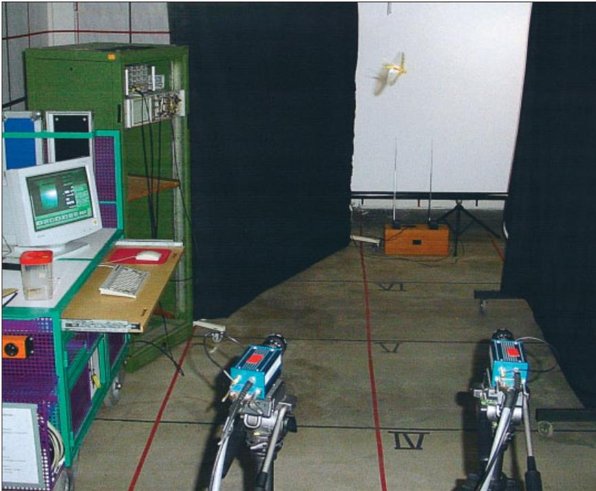
Ein Flugraum zur Untersuchung des Kurvenflugs der Heuschrecke: Das Versuchstier fliegt durch einen dunklen Korridor auf die helle Rückwand zu und dreht dann zur rechten Öffnung ab. Die elektrische Aktivität der einzelnen Flugmuskeln wird mit Hilfe von Sendern auf die beiden am Boden stehenden Empfänger übertragen. Zugleich zeichnen zwei spezielle Videokameras das Flugmanöver auf.
