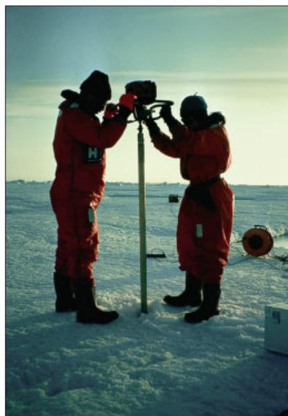
Mit Hilfe eines motorgetriebenen Bohrers können Eiskerne mit einem Durchmesser von 10 Zentimetern gewonnen werden. Rechts: In einem Kühlcontainer an Bord der „Polarstern“ werden polare Organismen aufbewahrt und untersucht.
