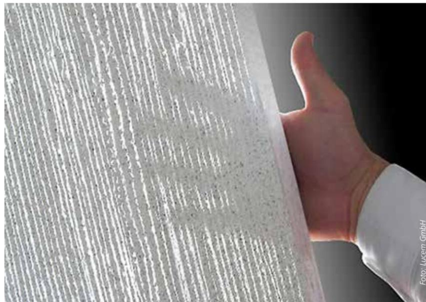
Links: Markenzeichen „durchscheinend“: Neue Faserwerkstoffe und eine neuartige Technologie ebnen den Weg zu lichtleitendem Beton. Rechts: Solche Bauteile könnten vielseitig eingesetzt werden. Blick in einen Gang mit Lichtbetonelementen.
