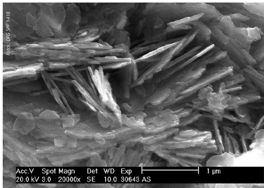
Nanoplättchen auf Aluminiumoxid-Basis erhöhen die Thermoschockbeständigkeit in kohlenstoffgebundenen Feuerfesterzeugnissen – weniger Kohlenstoff wird gebraucht.
