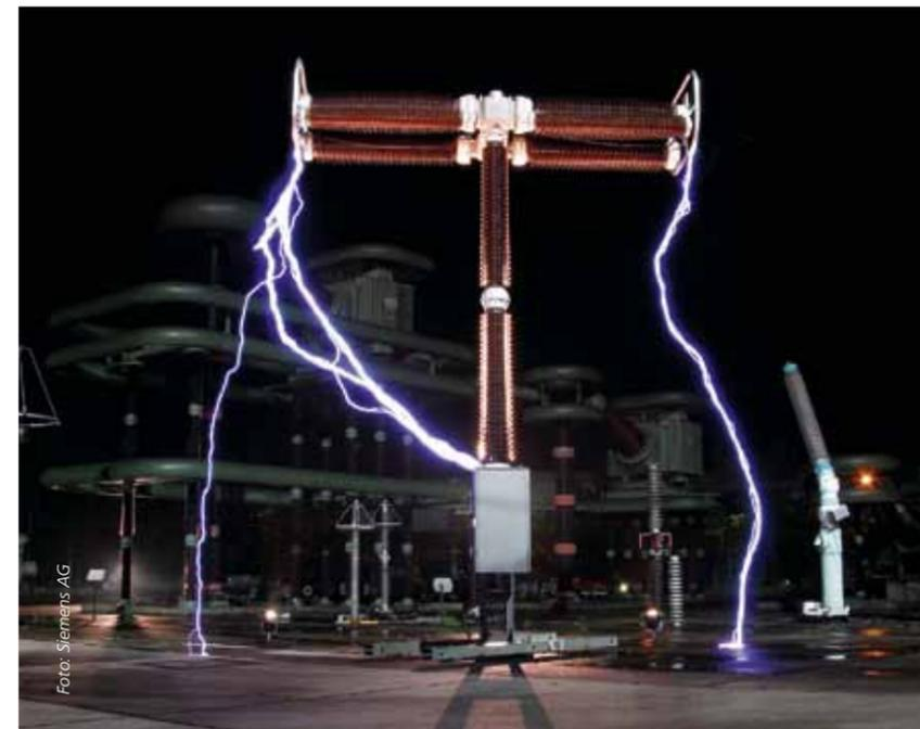
*Hochspannungsleistungsschalter bei der Hochspannungsprüfung*
