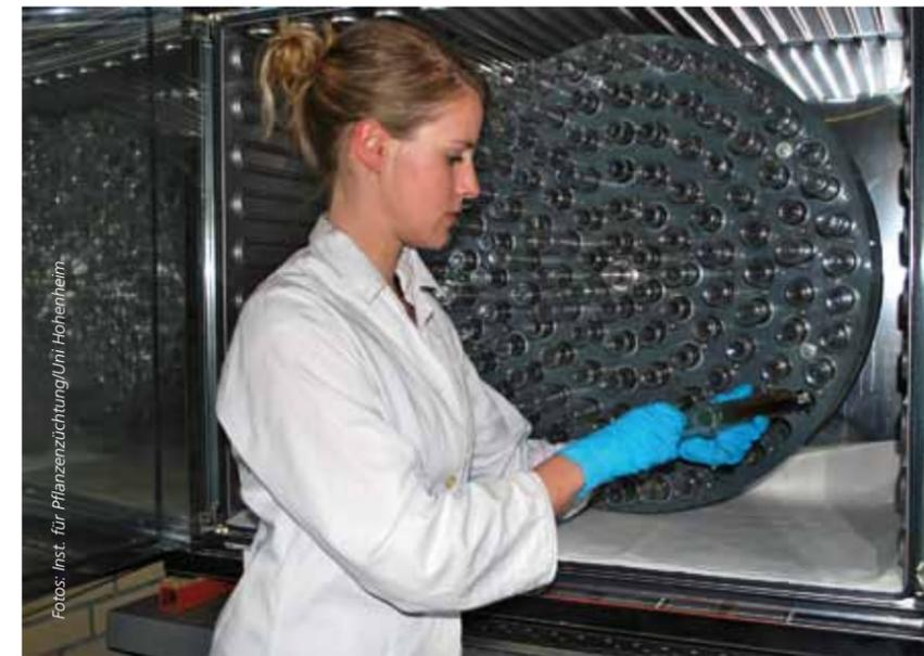
Mit Kleinfermentern wird die Biogasausbeute von Maisproben nach dem Hohenheimer Biogasttest (HBT) in einem Brutschrank erfasst.
