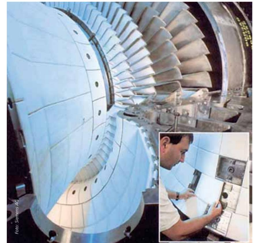
*Blick in Strömungsrichtung in die Ringbrennkammer einer Gasturbine mit vollkeramischer Brennkammerauskleidung zur Isolation der Brennraumwand*
