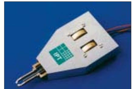
Nur 175 Mikrometer sind die Stahldrähte dick, die im Rasterelektronenmikroskop zusammengeschweißt wurden (oben). Kleines Bild: Bei der Handhabung der winzigen Bauteile hilft ein mechanischer Greifer. Rechts: eine Mikro-Schweißnaht.
