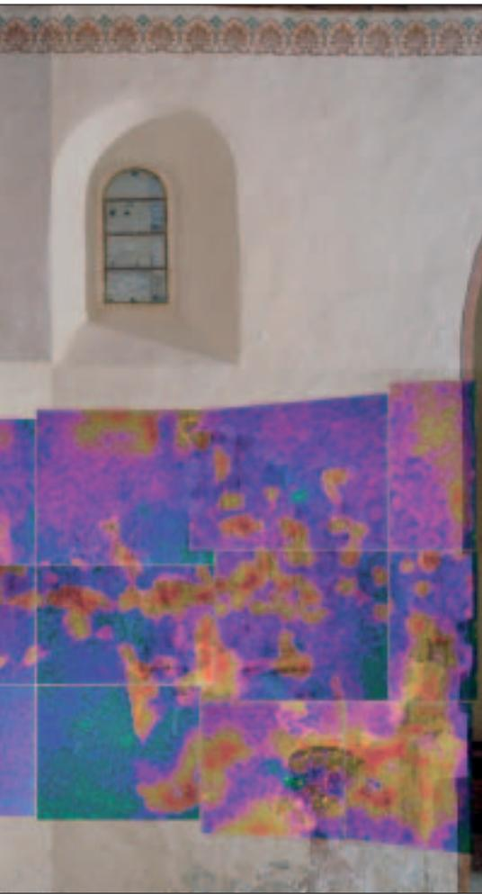
genden Objekt registriert ein „Interferometer“ also eine im Takt der Schwingungsfrequenz variierende Helligkeit. Interferometer können Verschiebungen anzeigen, die erheblich kleiner als die Lichtwellenlänge sind. Das neue Gerät, bei dem das interferierende Licht mit einer digitalen Videokamera aufgenommen wird, erlaubt unter günstigen Bedingungen sogar Schwingungen von wenigen Nanometern zu messen.
