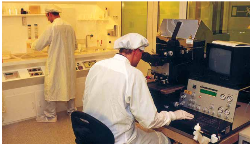
Strukturübertrag durch optische Lithografie im Reinraum unter Gelblicht.
