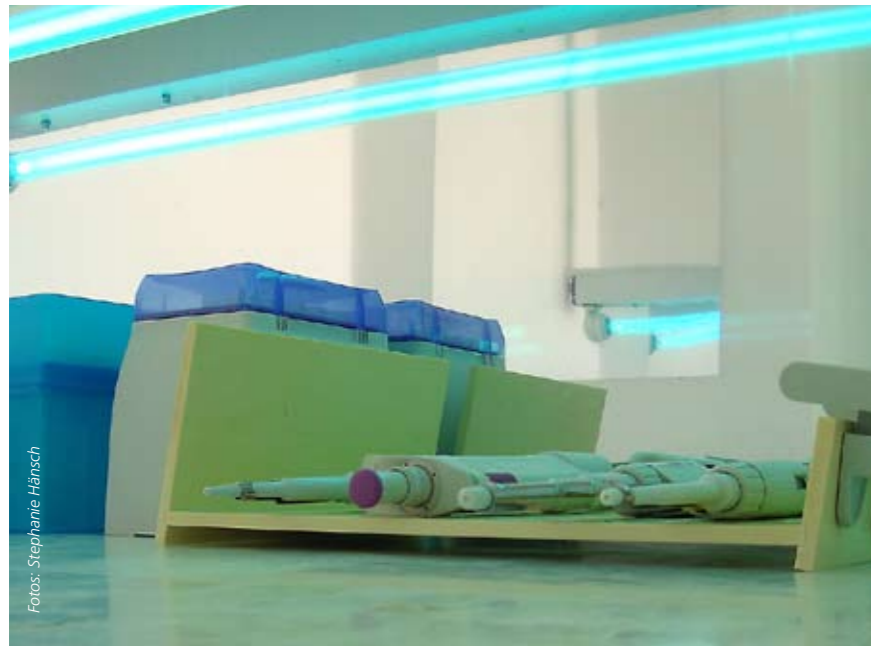
Laborgeräte unter UV-Licht. So sollen fremde DNA-Moleküle zerstört werden.
