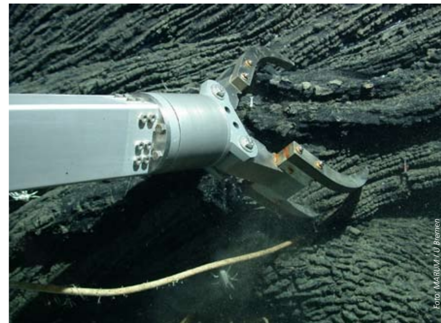
Kraftpaket in Aktion (oben): Der Tiefseeroboter „Quest 4000“ des Bremer Exzellenzclusters MARUM. Unten: Mit einem Greifarm nimmt der Roboter zahlreiche Asphaltproben vom Boden des Golfs von Mexiko, die später in Laboren untersucht werden.
