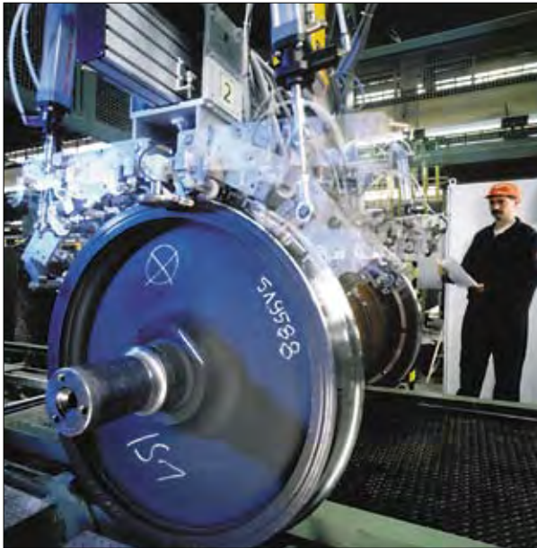
Контроль железнодорожных колес, Фраунгофер IZFP
