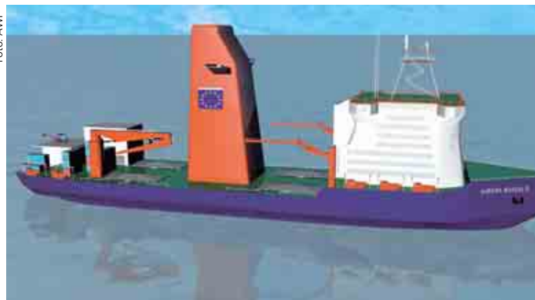
AURORA BOREALIS – der projektierte europäische Forschungseisbrecher ist mit einer Tiefseebohranlage ausgestattet und wird sogar im winterlichen Packeis der Arktis arbeiten können.
