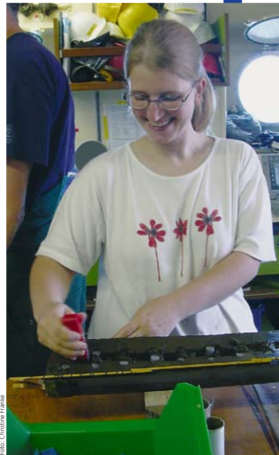
Aus einem Bohrkern entnimmt Christine Franke eine Sedimentprobe.
