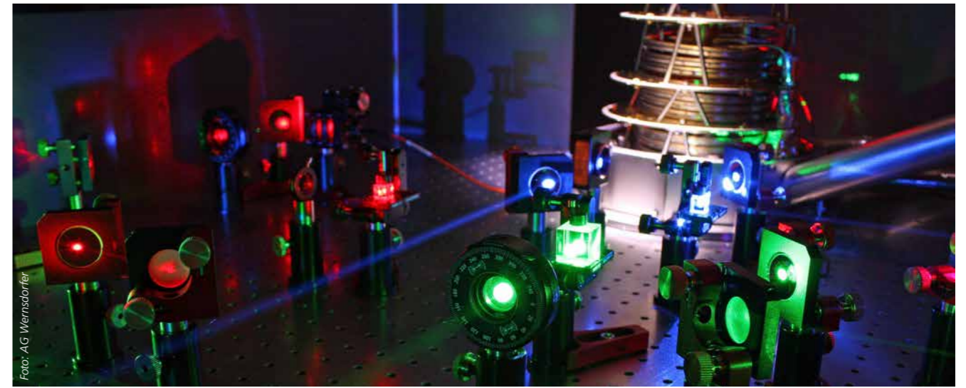
Optischer Aufbau eines Lasersystems. Dieses wird eingesetzt, um Quantenzustände basierend auf Störstellen in Diamant auszulesen.
