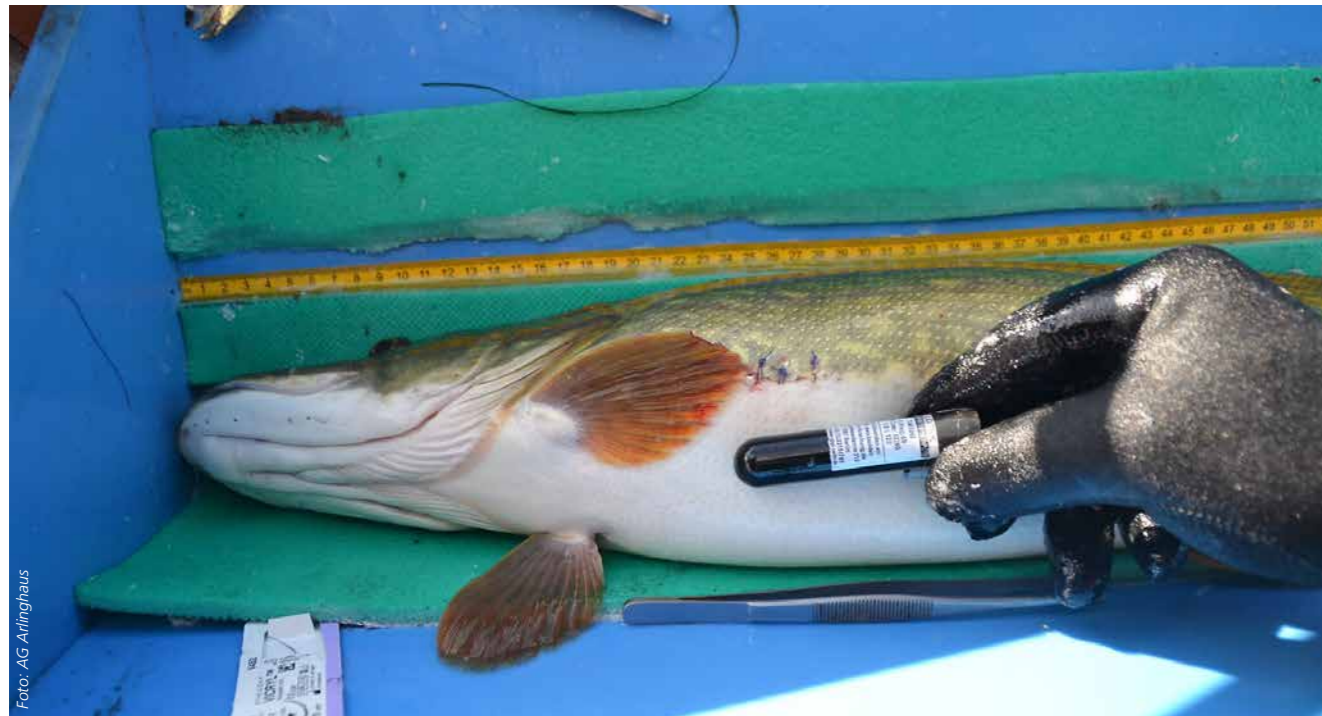
Zur Nachverfolgung bekommt der Fisch einen Ultraschallsender, der mit hoher Pulsrate (zum Beispiel alle 5–10 Sekunden) Ultraschallsignale (zum Beispiel auf der Frequenz 76 kHz) über mehrere Monate (oder sogar Jahre, je nach Batteriegröße) hinweg aussendet.
