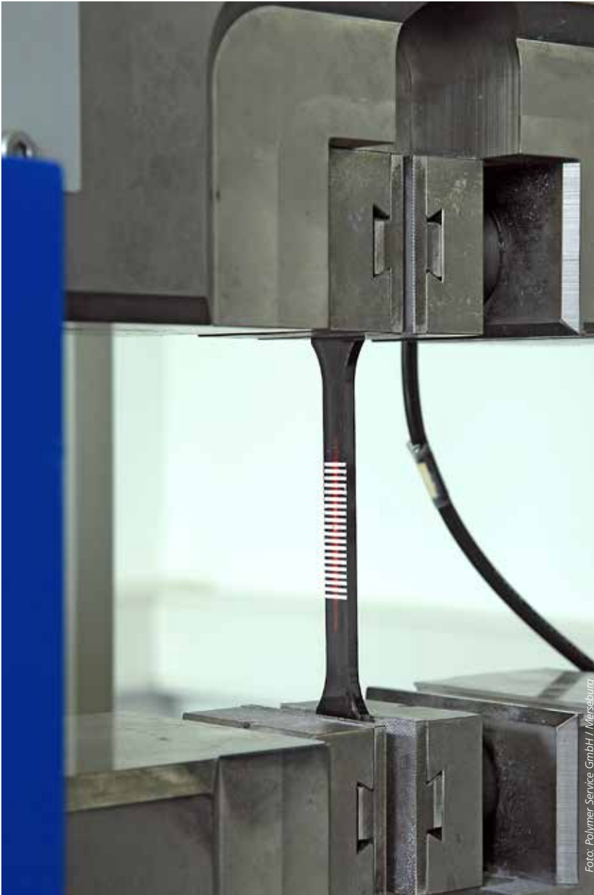
Ein Prüfkörper wird untersucht. Die Grundlagenforscher richten ihren Blick auf die Haltbarkeit von Elastomerbauteilen.
