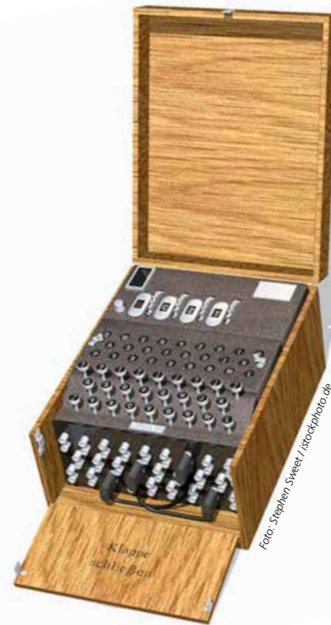
Äußerlich einer Schreibmaschine ähnlich: die Verschlüsselungsmaschine „Enigma“, die im Zweiten Weltkrieg eingesetzt wurde.
