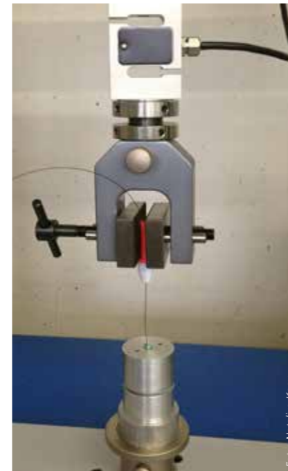
Standhaft: Aufbau zur Messung der Steifigkeit der Führungsdrahtspitze.
