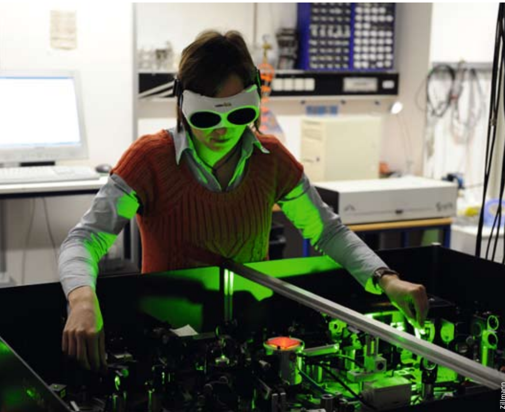
Daša Kaliská am Gigawatt-Ultrakurzpuls-CPA-Laserverstärkersystem des TRR 61 in Münster, mit dem zum Beispiel eine zeitaufgelöste Röntgenbeugung von funktionalen Molekülsystemen gelingt.
