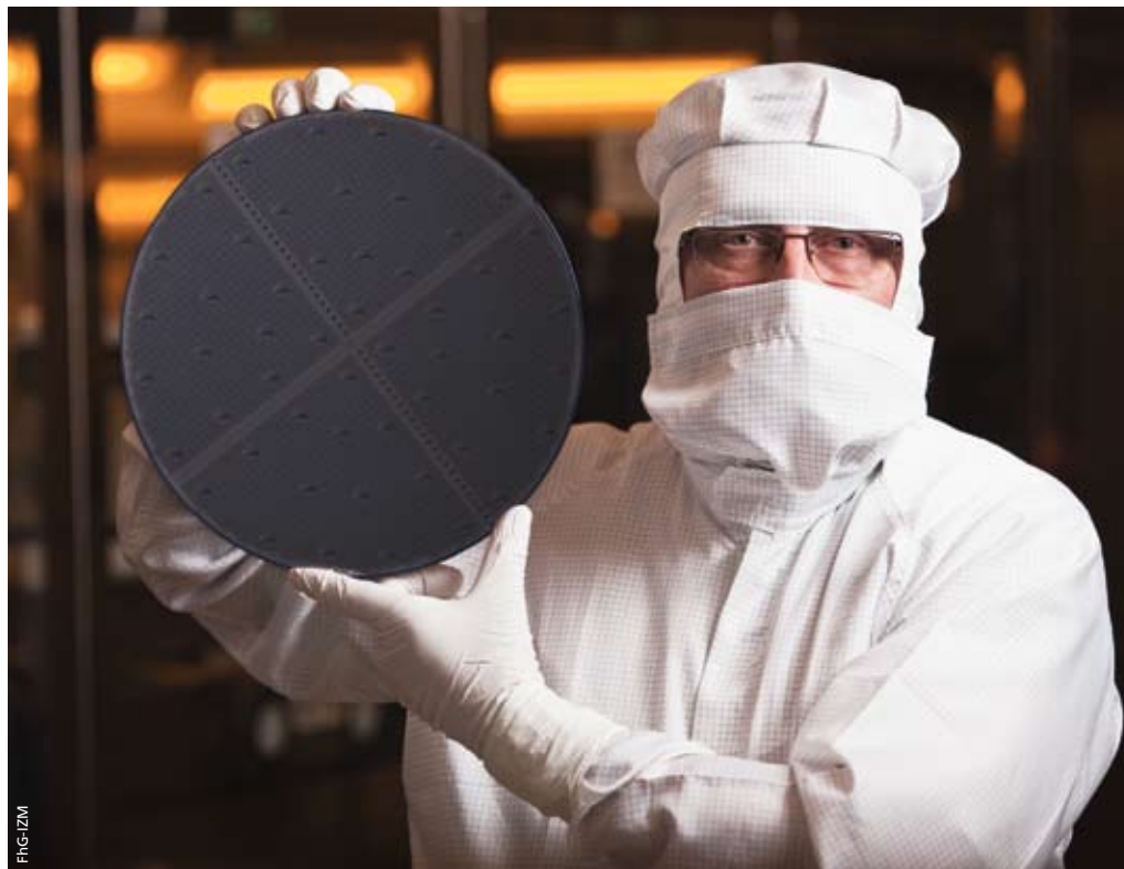
Während die Wafer aus Halbleitermaterial für die Chipproduktion immer größer werden – mehrere Hundert Mikrochips passen auf diesen 300-mm-Wafer – werden die Strukturen im Chip selbst immer kleiner: Die sichere Verdrahtung von bis zu einer Milliarde Transistoren auf einem einzigen Chip ist das Thema des Internationalen Graduiertenkollegs 1215.
